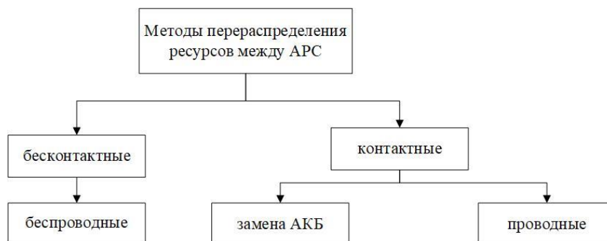
Рисунок 1 – Классификация методов распределения ресурсов между компонентами роевой системы
