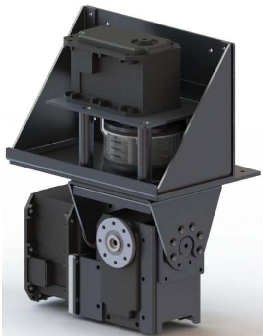
Рис. 23. Тазовый трехосевой механизм
