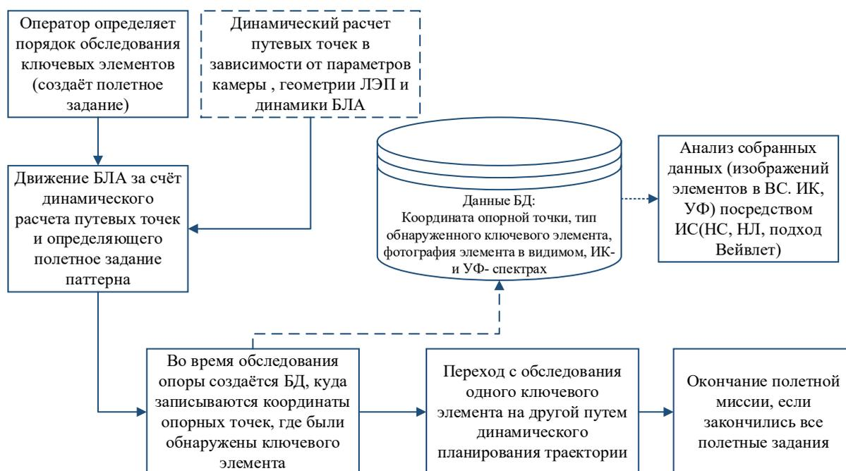
Рисунок 11 - Основные этапы подхода к определению состояния элементов ЛЭП
