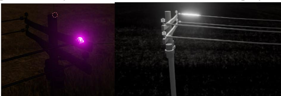
Рисунок 28 – Примеры постобработки полученных изображений для имитации УФ (слева) и ИК (справа) спектра
