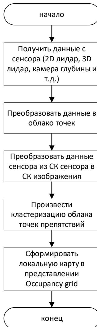
Рисунок 3 – Блок-схема алгоритма построения локальной карты на основе данных с сенсоров БПЛА
