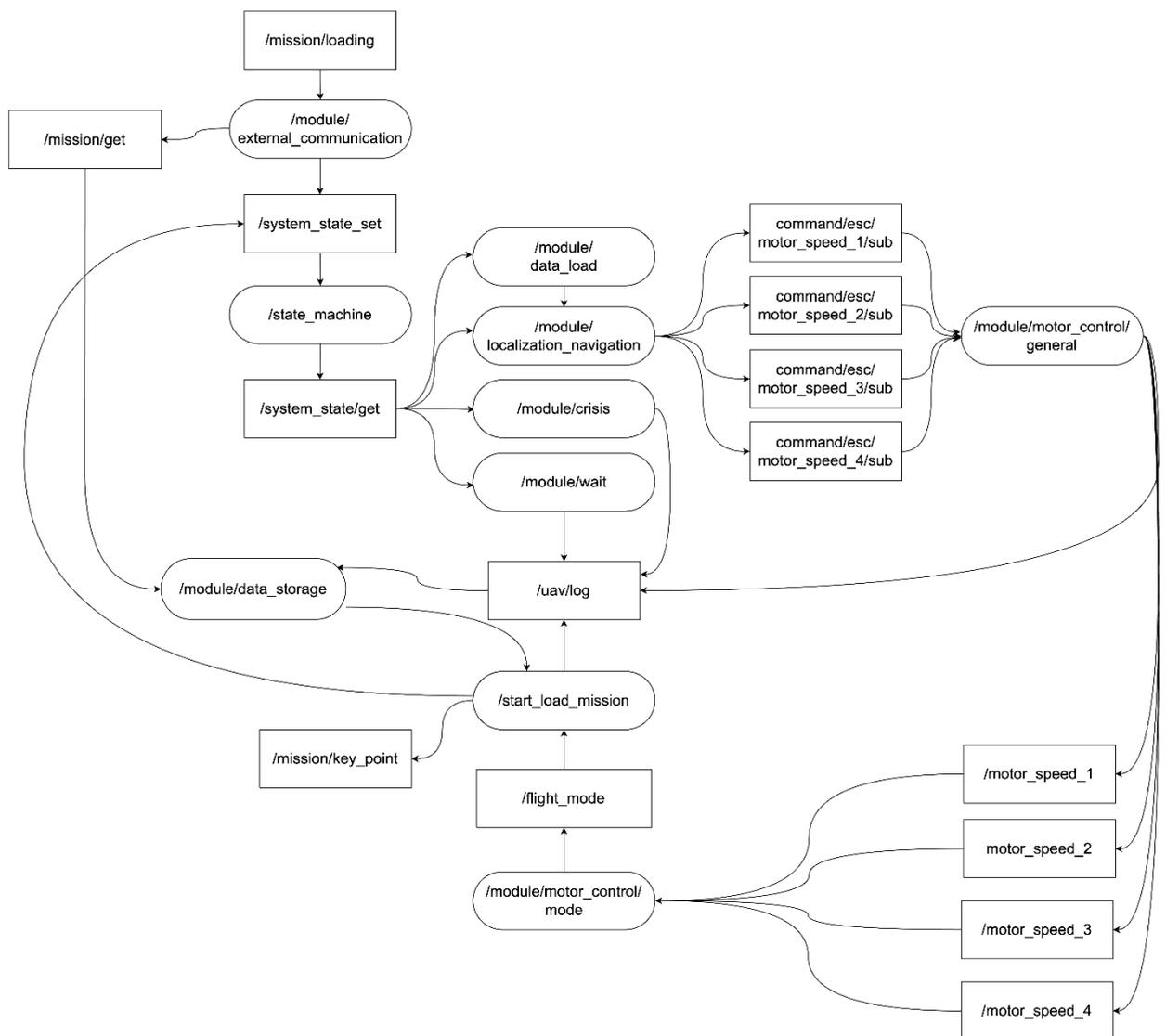
Рисунок 13 – Структура функционирования модели в ROS
