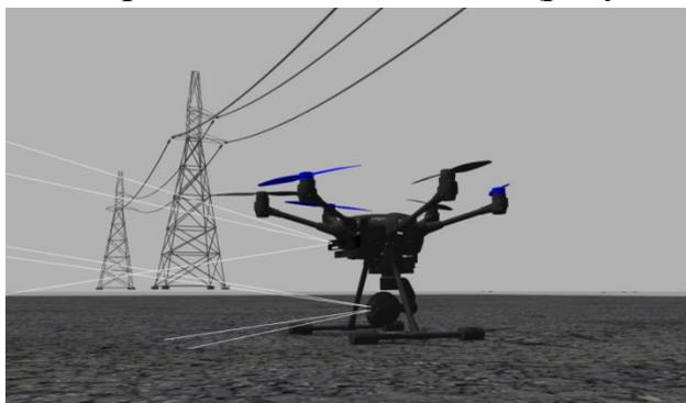
Рисунок 15 – Модель БПЛА и ЛЭП в симуляторе Gazebo
