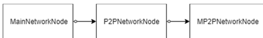
Рис. 19. Организация слоев архитектуры сетевого соединения на стороне клиента
