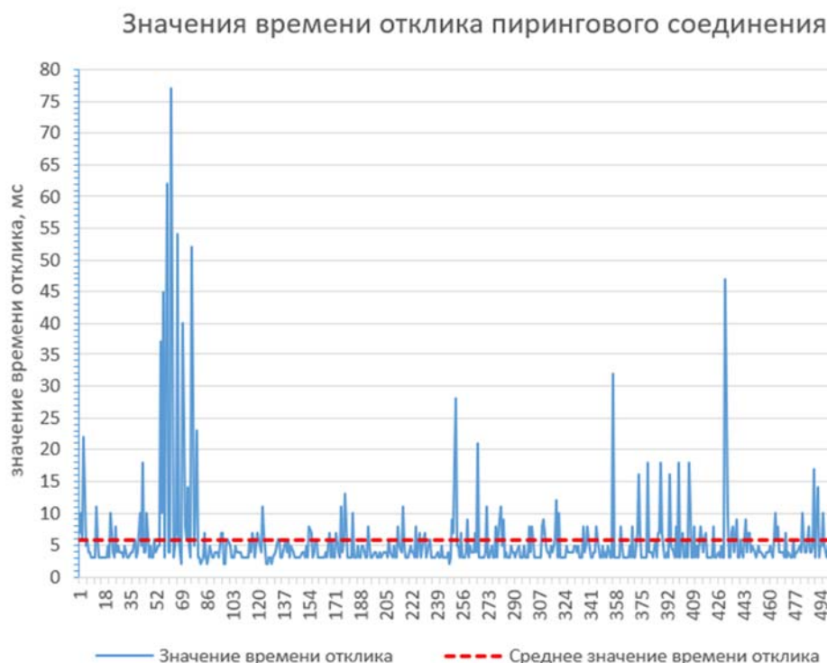
Рис. 20. Значения времени отклика пирингового соединения, установленного посредством разработанного программного обеспечения
