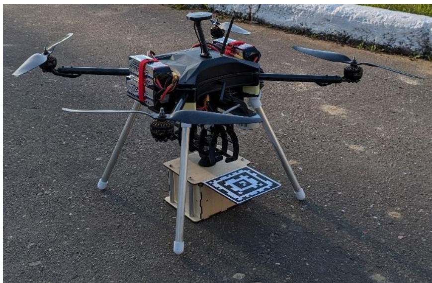
Рисунок 81 – БВС с устройством захвата и датчик сейсмической активности с транспортировочным креплением
