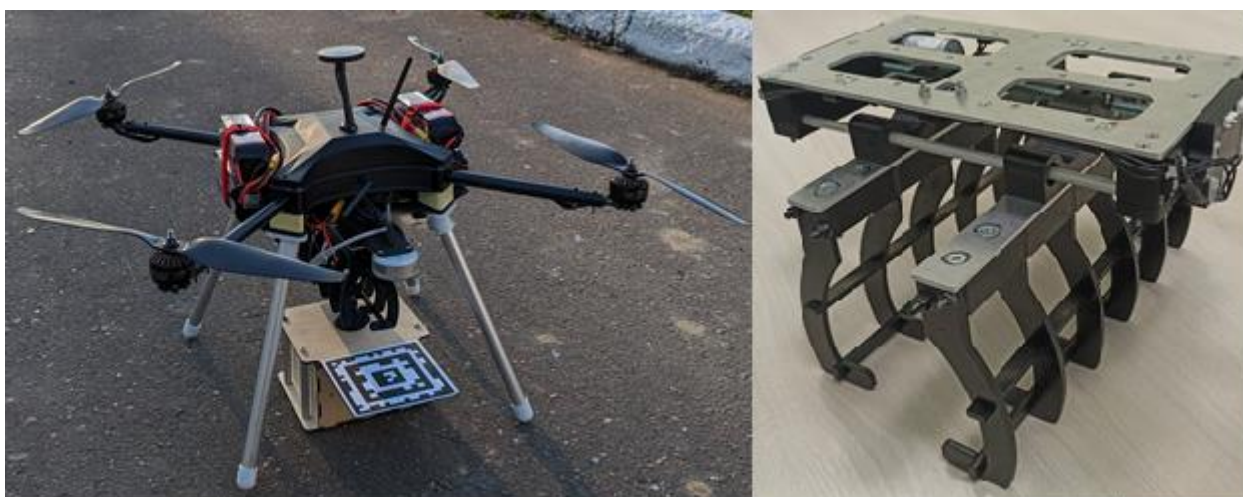
Рис. 2. Разработанное СПб ФИЦ РАН беспилотное воздушное судно с устройством захвата
