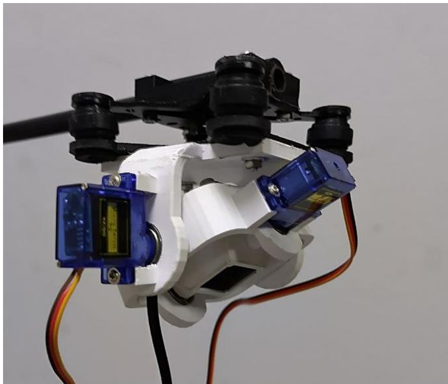
Рисунок 86 – Виброразвязанный двухосевой гиостабилизирующий подвес
