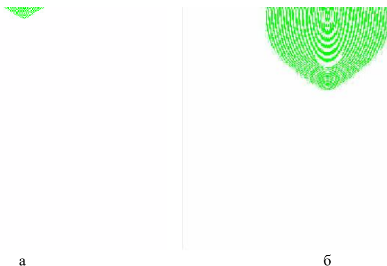
Рисунок 4 – Распространение волны в константной среде с дифрактором (а – начальное распространение; б – момент начала прохождения дифрактора)
