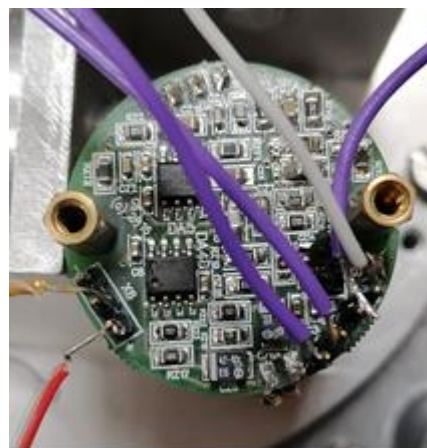
Рисунок 16 – Схема подключения АЦП и ЦАП при тестировании сейсмического датчика
